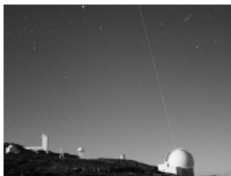
Figura 30. Prueba del sistema de estrella artificial efectuada el 5 de abril de 2004 como parte de los preparativos para el sistema GLAS 62 . GLAS permitirá la observación con óptica adaptativa en el 100% del cielo accesible desde el telescopio William Herschel. Fuente: Javier Méndez.
